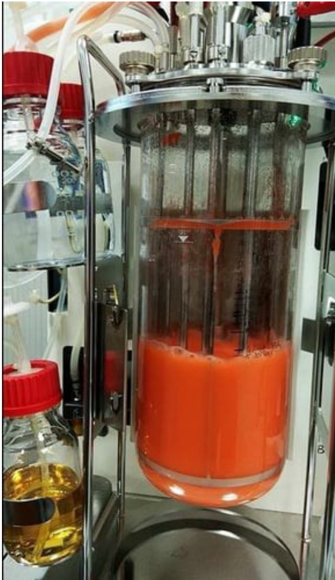
Denne bioreaktoren inneholder rød gjærsopp.
