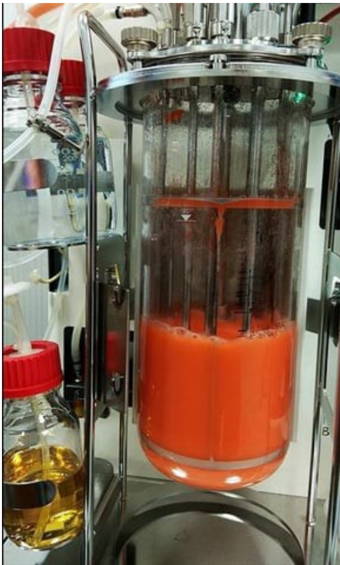
Denne bioreaktoren inneholder rød gjærsopp.
